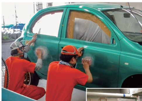
板金工作基本実習 (下地処理作業)
