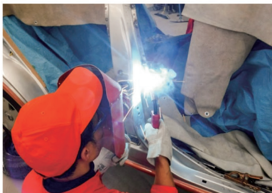
応用実習 (センターピラー 交換作業)
