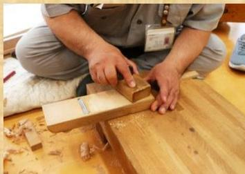
鉋の下端を「台直し鉋」という専用の鉋を使い、ごく僅かな量を削りながら調整をします。
