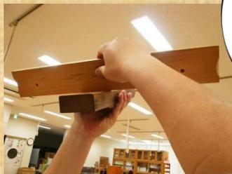
削ったら、楡でできた定規を当てて光に透かし、そこから僅かに漏れ出た光の量で下端の状態を確認します。
