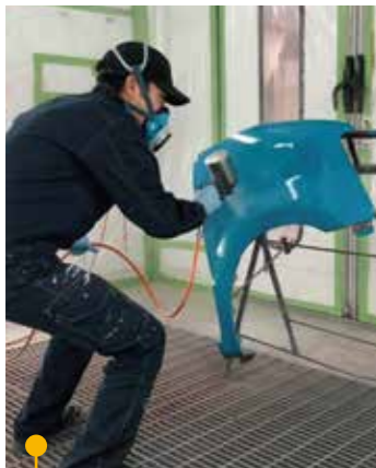
「応用塗装作業」(実技) 自動車塗装の仕上げをしています。
