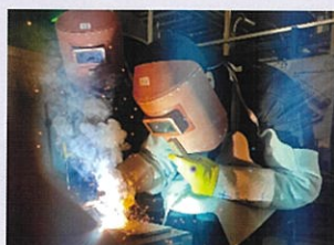
被覆アーク溶接
