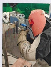
半自動アーク溶接
