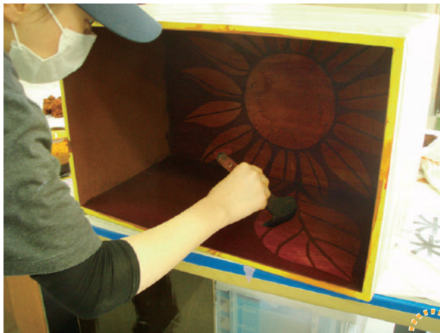
木工塗装作業（着色作業）
