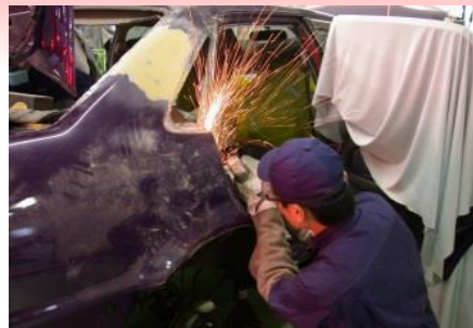
板金作業(パネル交換)
