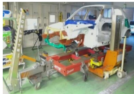
板金作業(フレーム修正)
