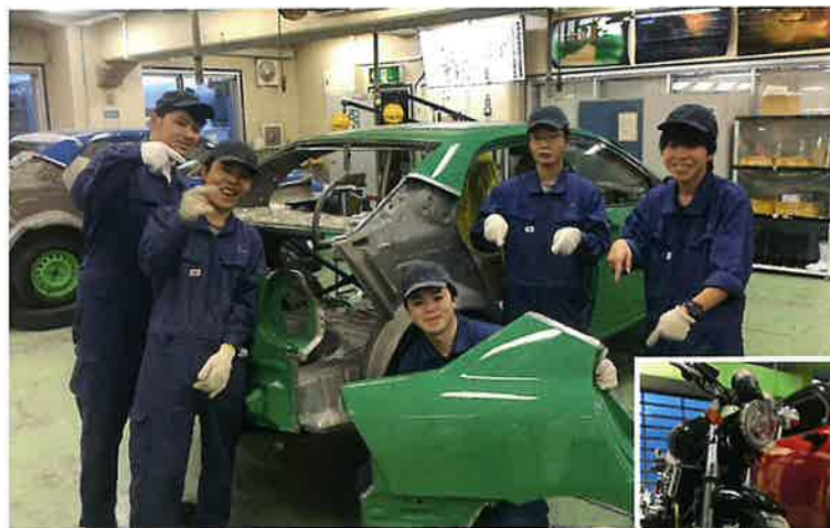
溶接パネル交換作業
