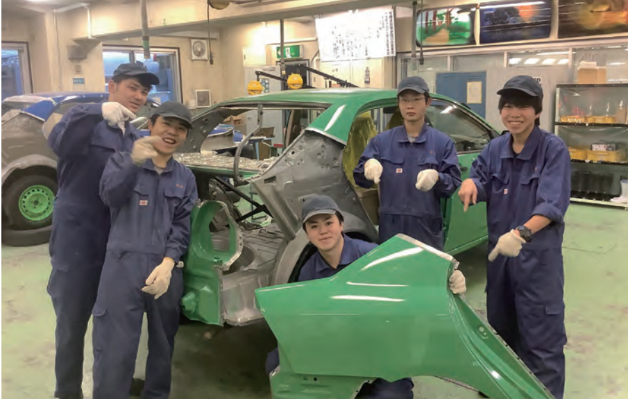
溶接パネル交換作業
