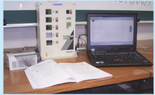
自動制御実習教材(エレベータ)
