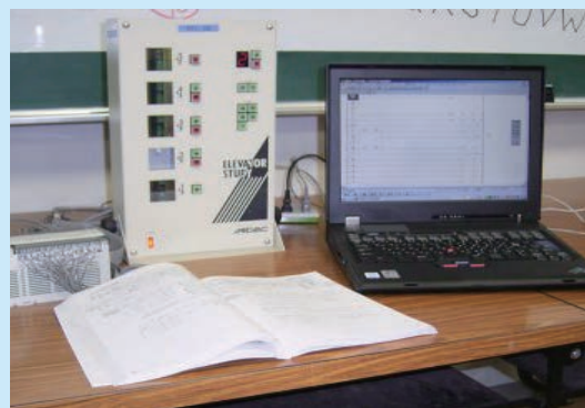
自動制御実習教材(エレベーター)
