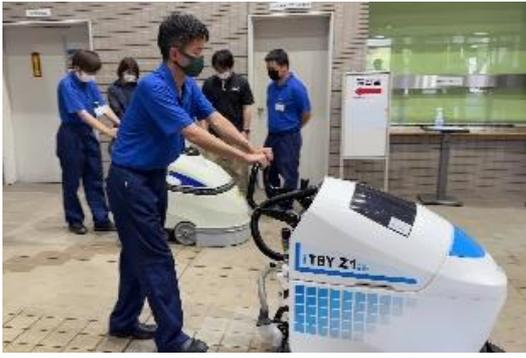
床面洗浄で使用するポリッシャー（モーターによって円形のブラシやバフを回転させ、床や車などを磨いて洗浄を行う掃除機械）の運転操作を体験します。
