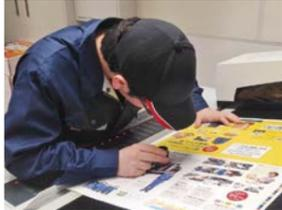
テスト刷りした印刷物が正しい位置で刷られているか確認し、色の濃さを調整します。
