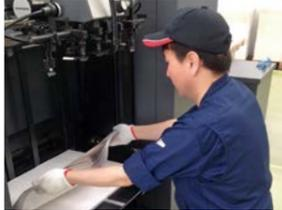
印刷用紙に空気を入れて整え、印刷機にセットします。
