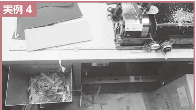
実例3と同様に革すき機の下に集じん機を設置したケースです。以前は室内に飛散していたすきくずが容器の中に吸い込まれ、室内の空気がきれいになりました。
